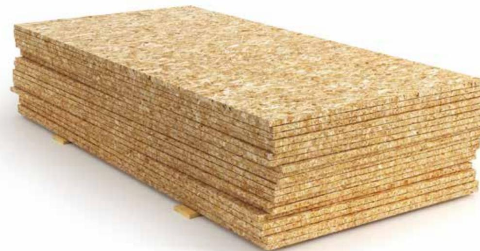
La densità varia a seconda del prodotto in funzione della tipologia di legname e del processo di fabbricazione. **La densità è compresa tra i 600/680 kg/mc**. Grazie alle **elevate proprietà meccaniche**, l' OSB è particolarmente adatto a **funzioni di sostegno**, in particolare nelle **costruzioni**, ed è specificatamente utilizzata per **coperture di tetti e rivestimento pareti**.
